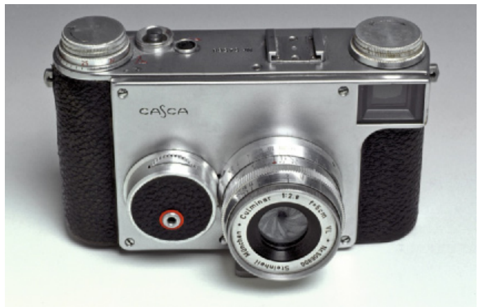
CASCA I med separate knapper til optræk og returspoling, samt en synkrobøsning på fronten. Formentlig en prototype. CASCA I med Culminar 4,5/135 mm og revolver søger.
