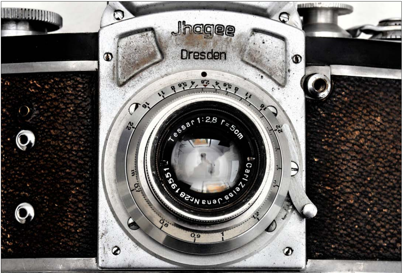
Tessar 1:2,8 f=5cm nr.2819551 må være produceret af Carl Zeiss i Jena mellem 1942 og 1945.
