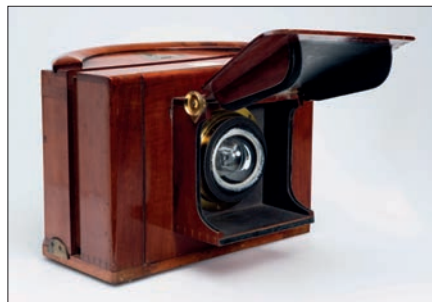
Opstilling: Thomas Sutton panoramakameraet med 100 graders buet negativpladeholder for glasnegativer.
