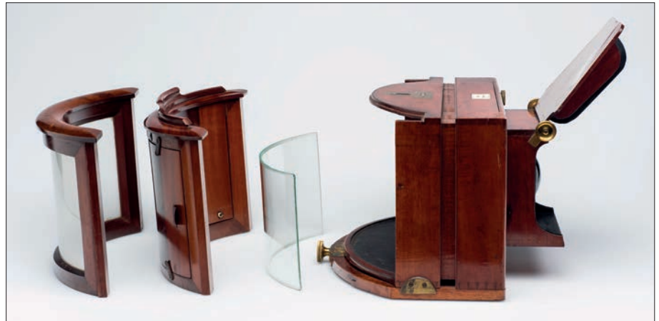
Opstilling: Thomas Sutton panoramakameraet med 100 graders buet negativpladeholder for glasnegativer.
