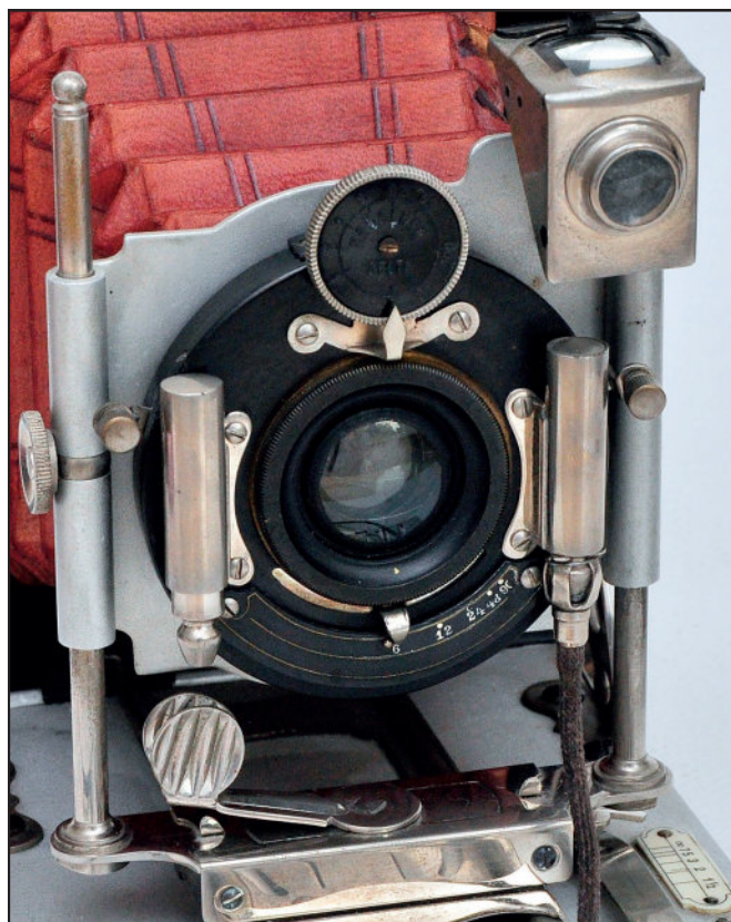
Kameraets front med den pneumatiske Delta lukker.
