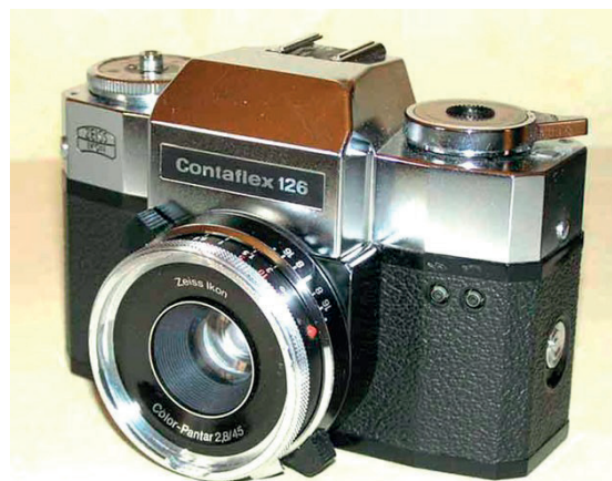
Contaflex 126, 1969, SLR-kamera til Instamatic-format, med TTL-måler og blænderautomatik
