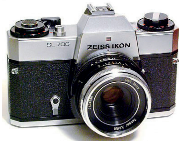
Zeiss Ikon SL 706, 1971, de sidste krampetrækninger, i grunden et Icarex 35 S, men nu med TTLmåling ved fuld åben blænde
