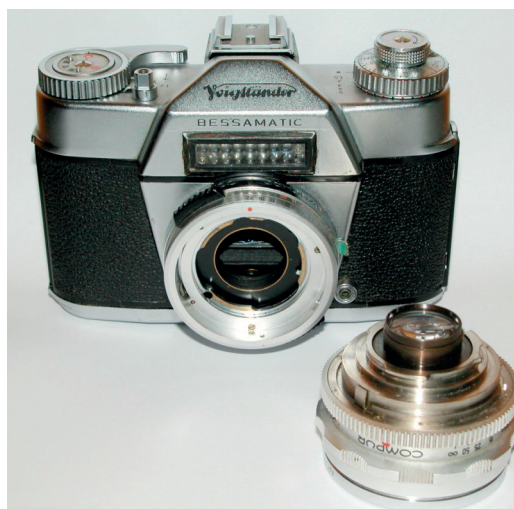
Bessamatic, 1958, i modsætning til Contaflexudskiftes her det komplette objektivet foran centrallukkeren
