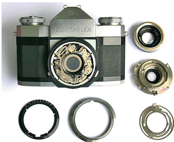
Contaflex Alpha, 1957, et kig ind i Prontorlukkeren
