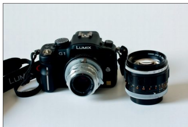
Lumix CR2. Panasonic G1 med Zeiss Tessar 50mm 1:2,8
