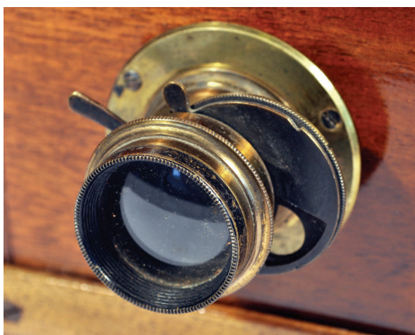
Objektiv med indbygget rotationslukker
