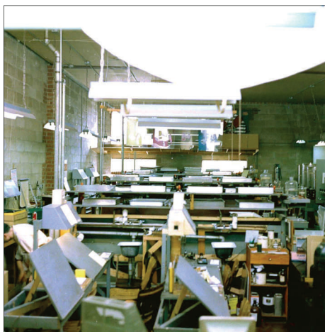
Alle bordene bevægede sig ved hjælp af små elektromotorer for konstant at vugge skålene med transfer-farver
