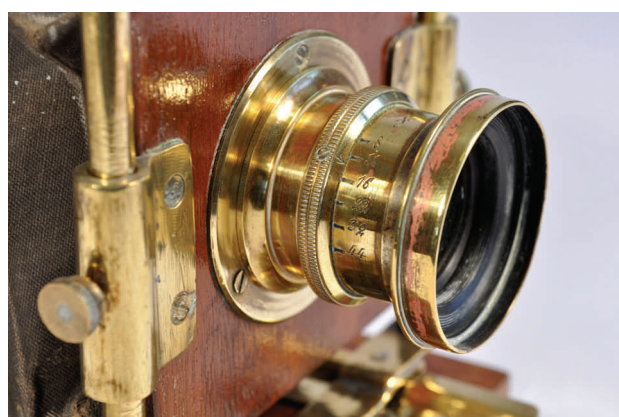
To eksempler på objektiver med irisblænder
