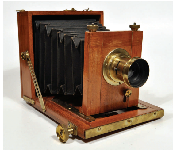
Fast bagstykke og forskydelig front (engelsk kamera)
