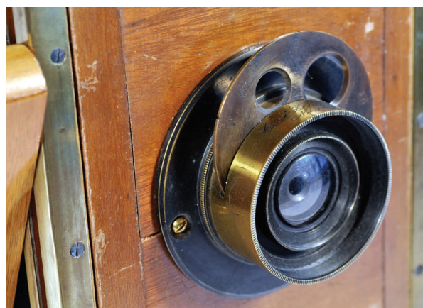
Objektiv med revolverblænde
