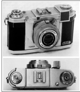
Tengoflex, fremstillet i begrænset antal og kun leveret til Sverige. Luftwaffe Tenax II, énhåndsbetjent, fastlåste tider 1/200 og 1/400 sek., afstand låst fast på uendeligt. Coated Tessar objektiv og gulfilter bag baglinsen.
