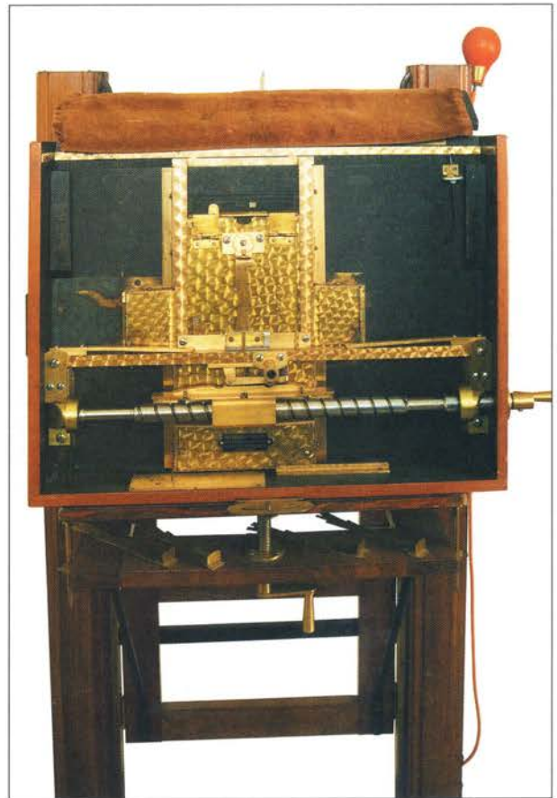
(7) Forkromet spindeldrev med udskiftelig sporskinne, som ved drejning af håndsvinget bevæger sig trinvis, svarende til antallet af spor i skinnerne, fra venstre til højre, ved næste linie fra højre til venstre o.s.v.
