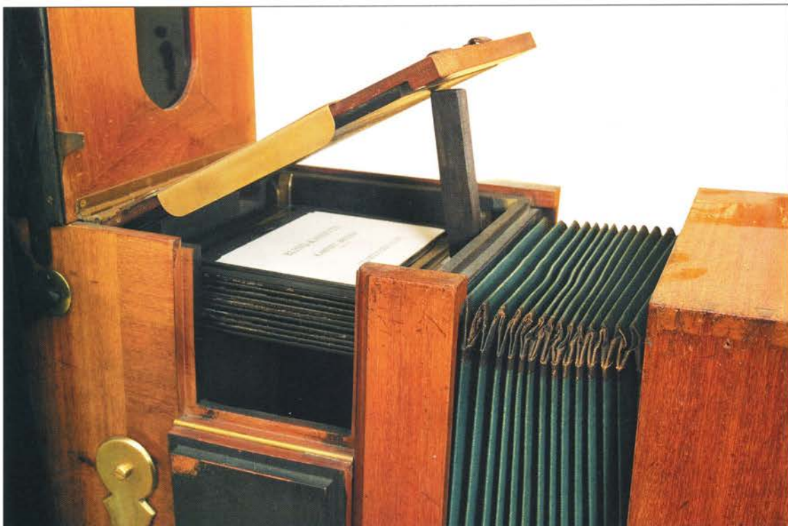
(5) Her anbringes det ønskede antal kassetter, med blindkassetten øverst.
