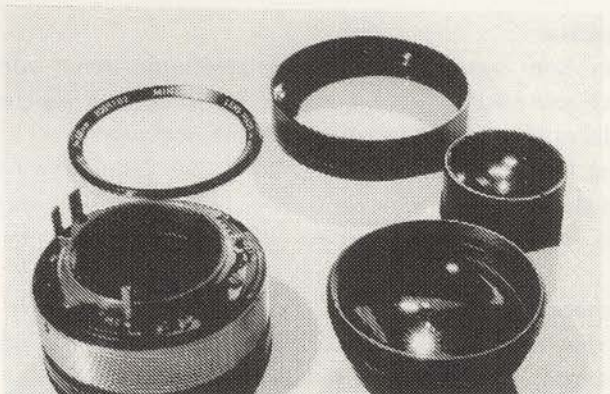
Det fine gevind skrues sammen til det noterede mål (22,65).
