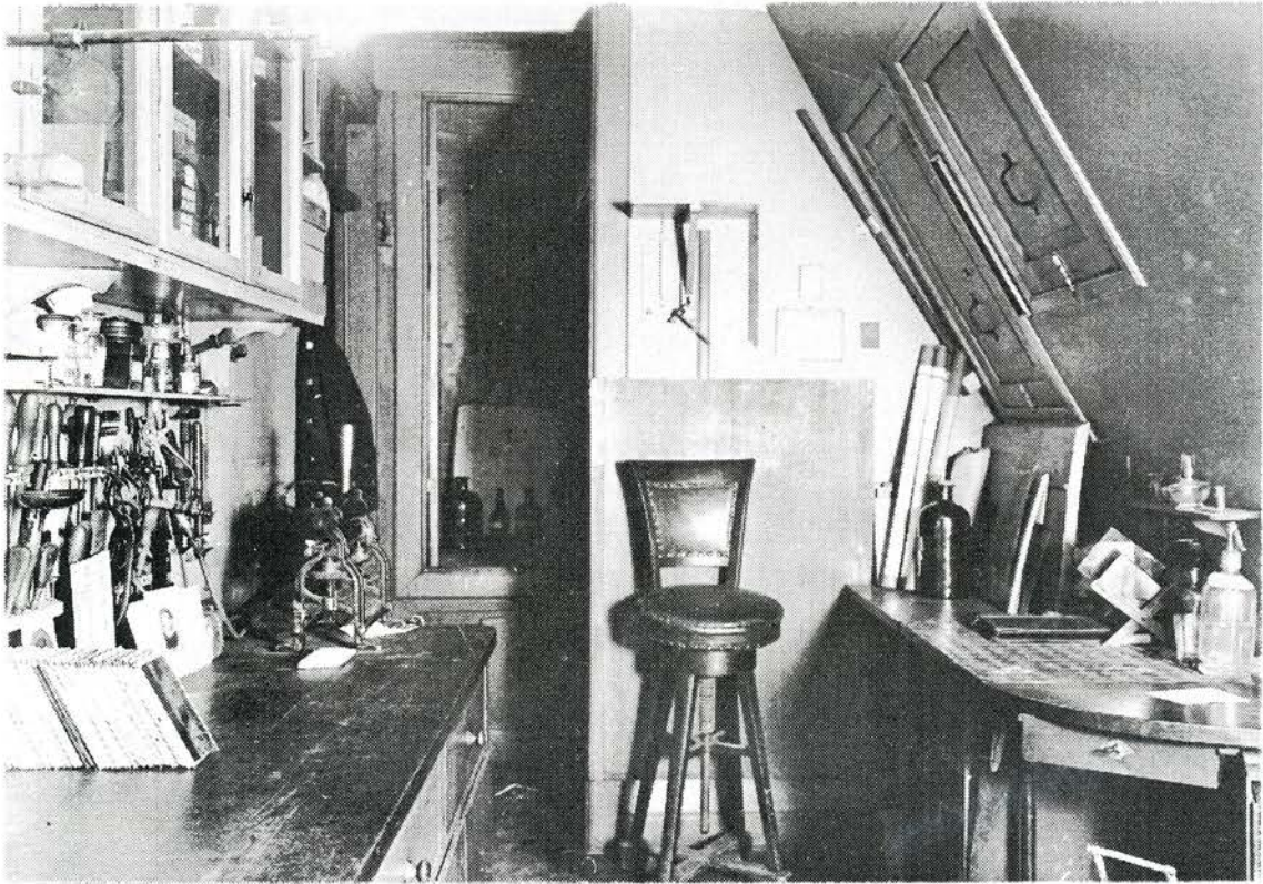
På bordet til højre står en 'tralle', en holder til glasplader. På hylden ovenover en spritbrænder. Den høje retouchstol står i nederste stilling. På væggen over stolen ses stålinkel- og linial til beskæring af billeder. En række færdigmonterede billeder står opstillet på bordet. På bagvæggen over bordet ses en række håndværktøjer beregnet til brug ved indramning af fotografier og montagearbejde samt en varmeklæbepresse til gas.
