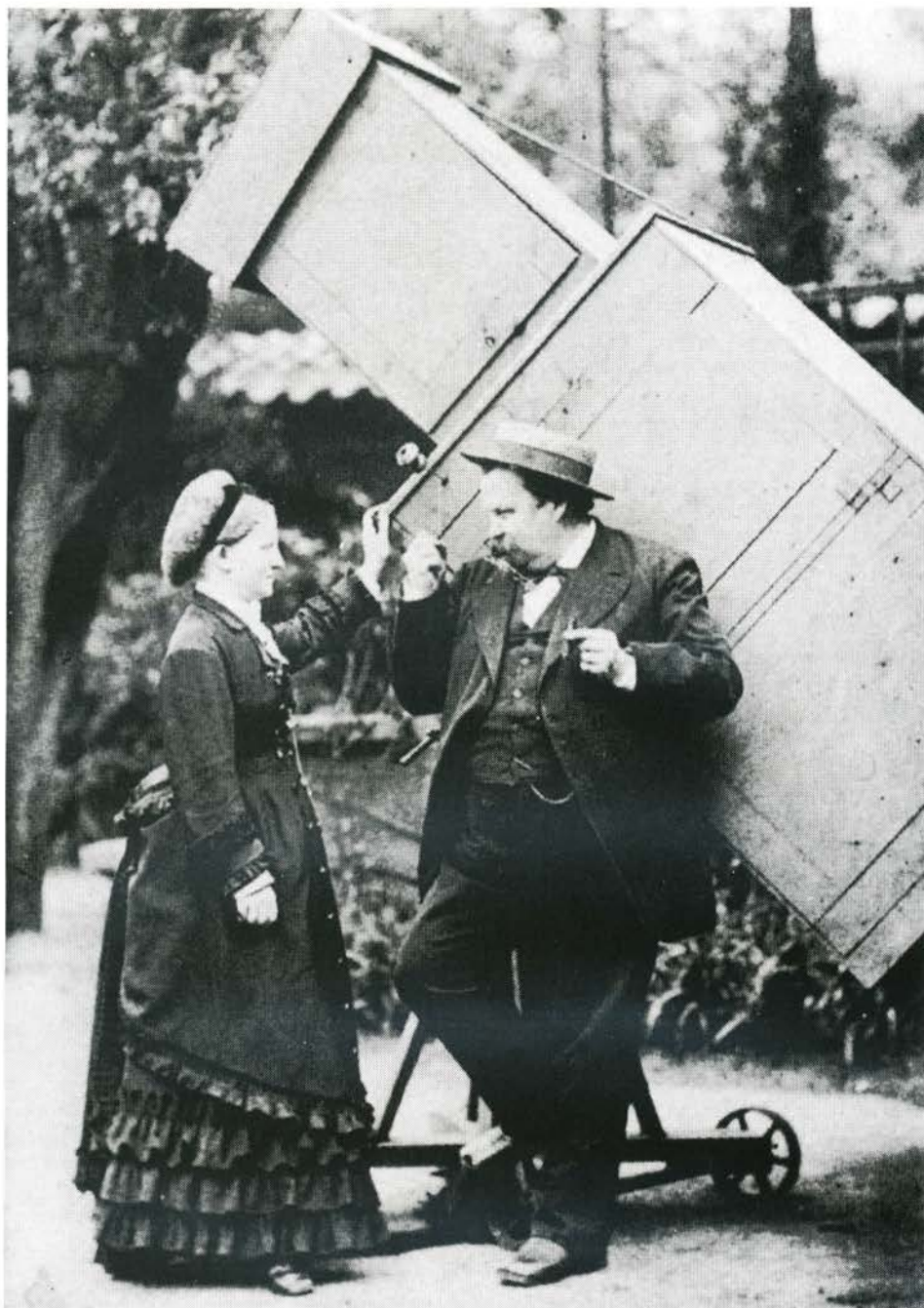
I Danmark er fotograf Georg E. Hansen (1833-1891) den første som i 1855 fremstiller gelatineplader og får konstrueret og installeret et solarkamera til produktion af forstørrelser. Nu kan der reklameres med billeder i legemstørrelse. Hans mørkekammer på Østerbro bliver hurtigt kendt som stedet, hvor man er på forkant med den teknologiske udvikling. Vi ser den afholdte og muntre fotograf med sin kone bag atelieret i Norgesgade
