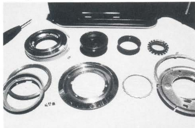
Så meget skal afmonteres på Vito CLR før man er inde i Prontor lukkeren.
