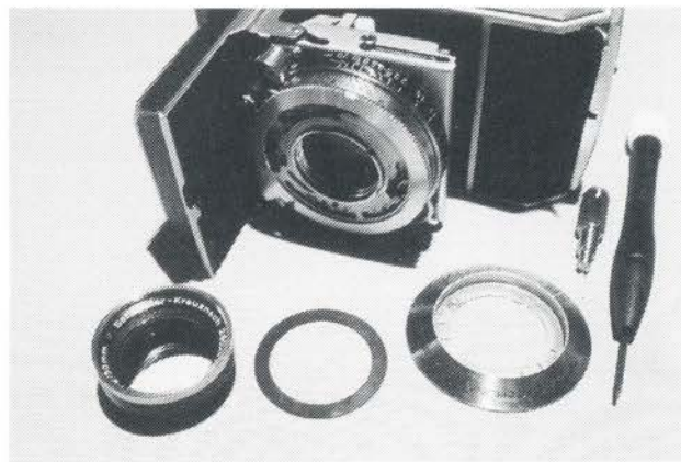
Efter at have fjernet 7 skruer er man inde i Prontor-S lukkeren på en Akarelle.
