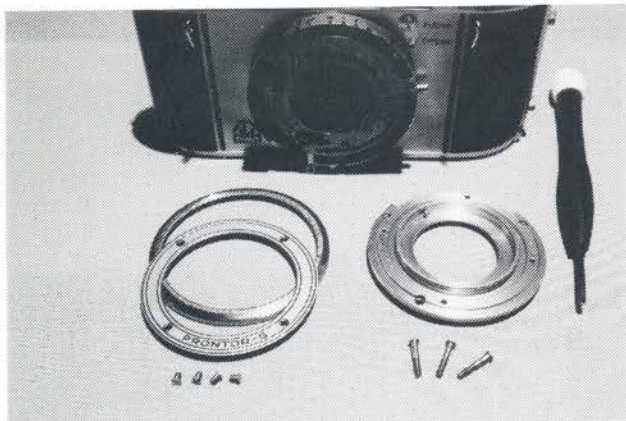
Der stor forskel på, hvor mange dele man skal fjerne for at komme til lukkeren forfra: så nemt kommer man ind til Compur lukkeren på en Retina IIa.
