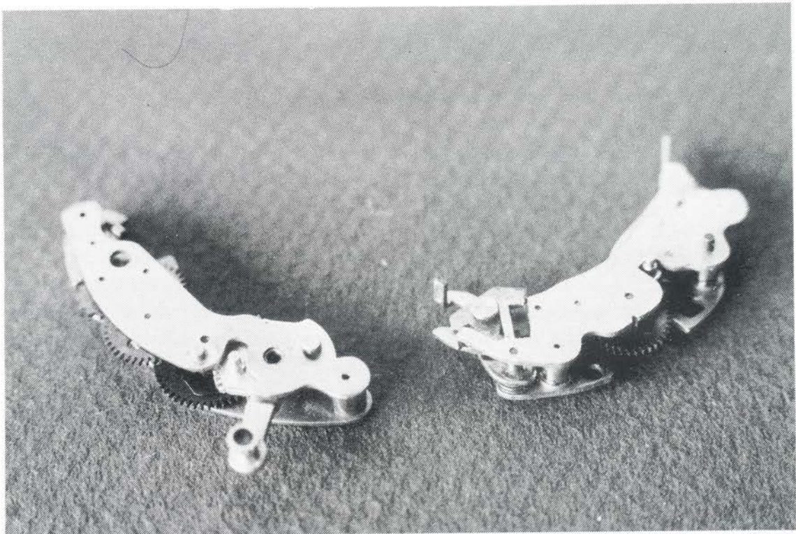
De afmonterede hemværker fra Prontor-lukkeren. De sidder fast med 2 skruer og 1 fjeder.
