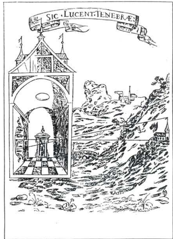
Når vi betragter camera obscurategningen fra 1696, ser man en lysstråle, som udgår fra pilens spids gå i en lige linie ned til c.o.'s bagvæg. Ser vi på pilens rod vil denne på samme måde ramme øverst i c.o.'s bagvæg, svarende nøjagtig til det punkt, hvorfra det udgik.
