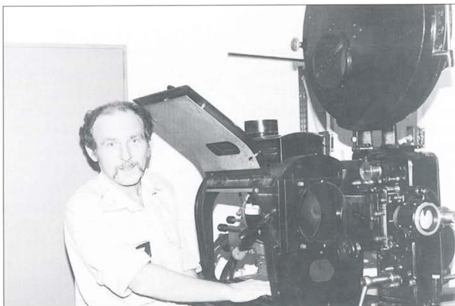
Kurt Petersen med sin kinomaskine på udstillingen i 1981 på Herlev Sygehus. Det er den klassiske model fra Ernemann/Zeiss Ikon „Ernon IV“ fra 1933.
