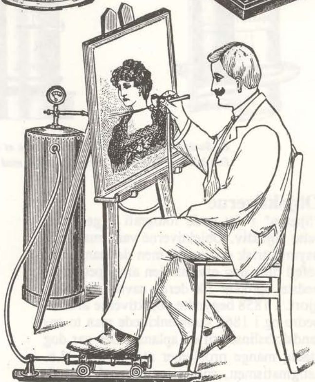
"Airostile" med lufttryk. Et avanceret udstyr til positivretouche og farvelægning. 1910.
