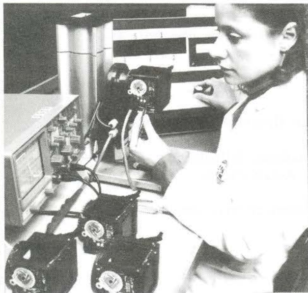
Justering af 200F spaltelukker ved brug af oscilloskop.
