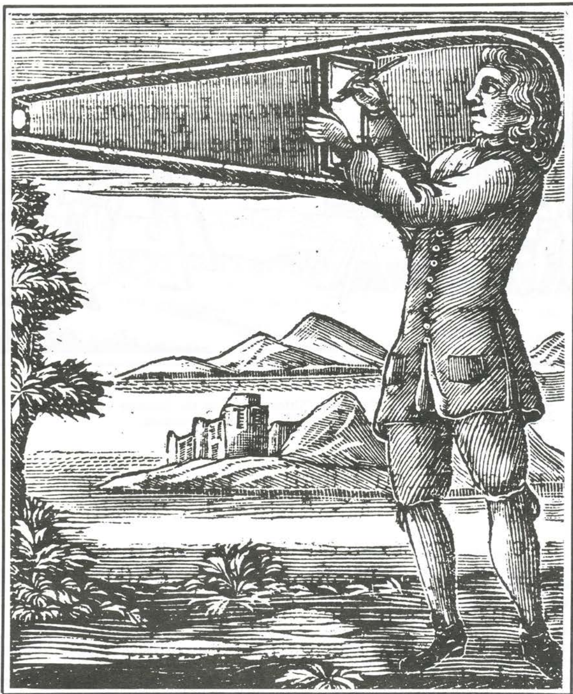
Udtræks-camera obscura af Robert Hooke, anvendt som tegneinstrument. 1694.
