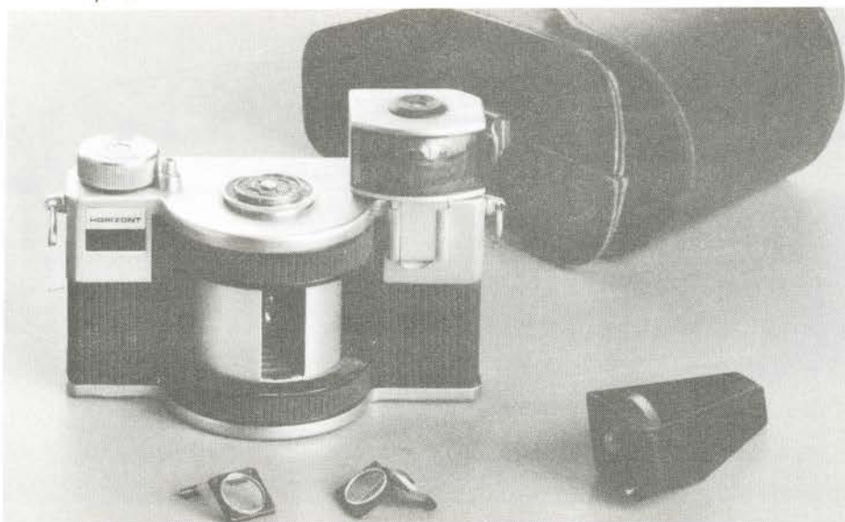
Horizont 35 mm 120° russisk panoramakamera. Objektiv OF f:2,8/28 mm. Lukker 1/30-1/250. Håndgreb. To svage samlelinser 2 og 4 mm brændvidde giver mulighed for afstandsindstilling. (P.P.).
