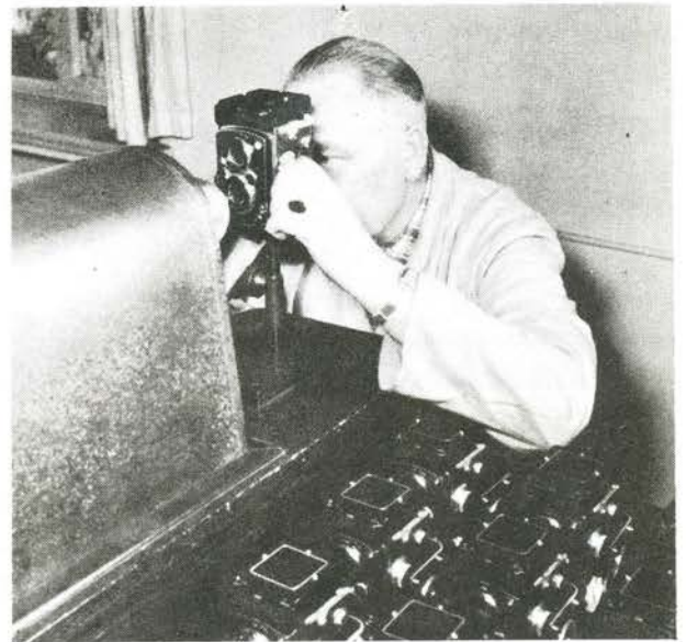
Optisk kontrol, hvor operatøren har taget en matskive på filmplanet og betragter motivet med en lup.
