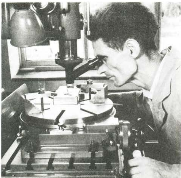
Værktøjsmager i arbejde ved et præcisionsboreværk. Emnet er opspændt på et rundbord. Han benytter et centeringsmikroskop.
