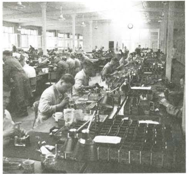
Finmekanisk montage af kamerahuse.
