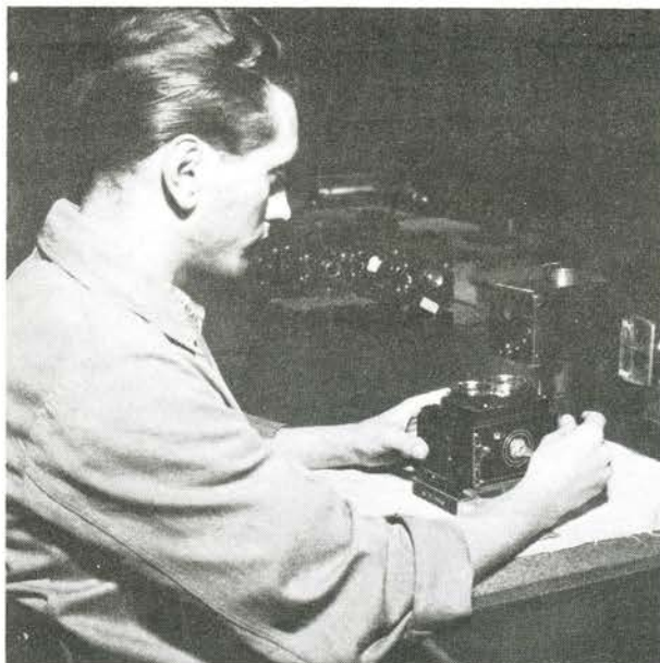
Her kontrolleres hvor mange gram tryk der skal til for at udløse kameraet.
