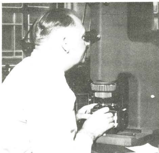
I en autokollimator justeres objektivet i forhold til filmplanet.
