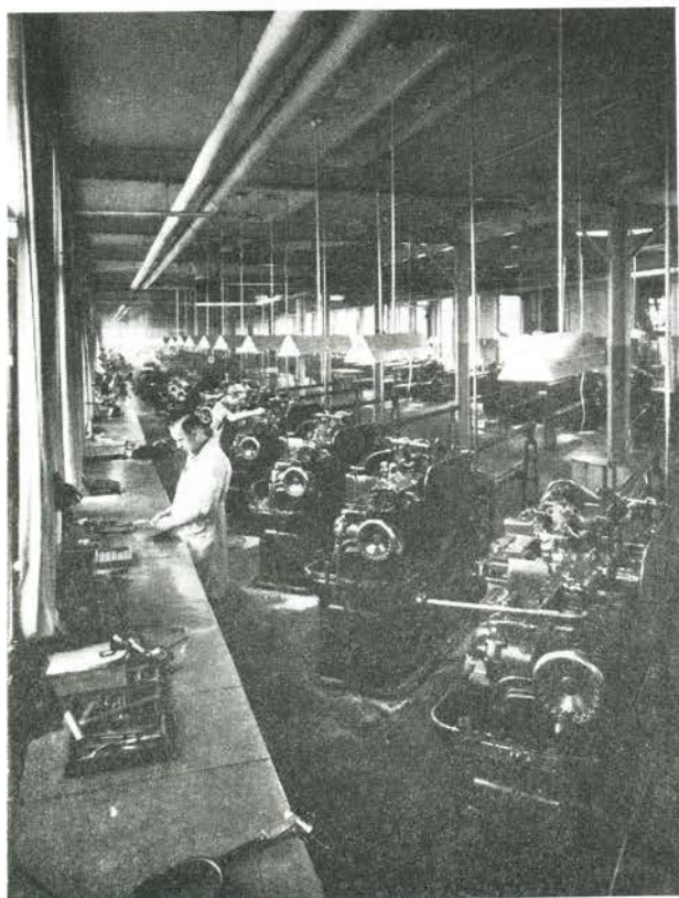
Automatdrejeafdeling hvor små drejemner fremstilles fra stangmateriale.
