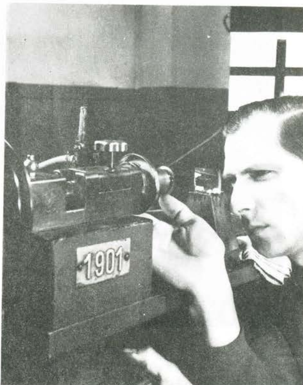
Optisk centrering. Operatøren ser gennem en lup det spejlbillede af krydset i baggrunden, som er på den roterende linse. Krydset skal stå helt stille når linsen er centreret.
