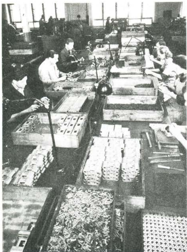
Afgratning af trykstøbte kamerahuse.
