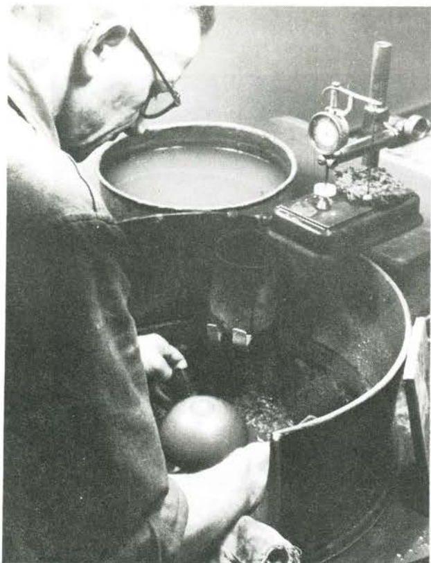
Efterjustering af linsetykkelse sker her ved at holde en linse mod en roterende kugle med lappekorn på.
