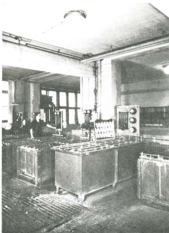
Galvanoafdeling. Kameradæksler ses i et galvanoophæng som dyppes ned i nikkel- og krombade.
