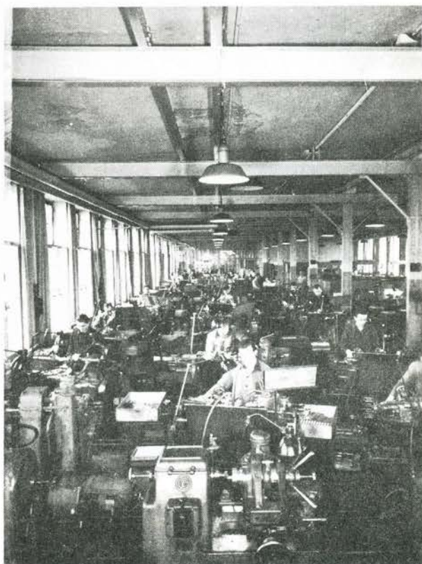
Drejeafdeling med revolverdrejebænke.
