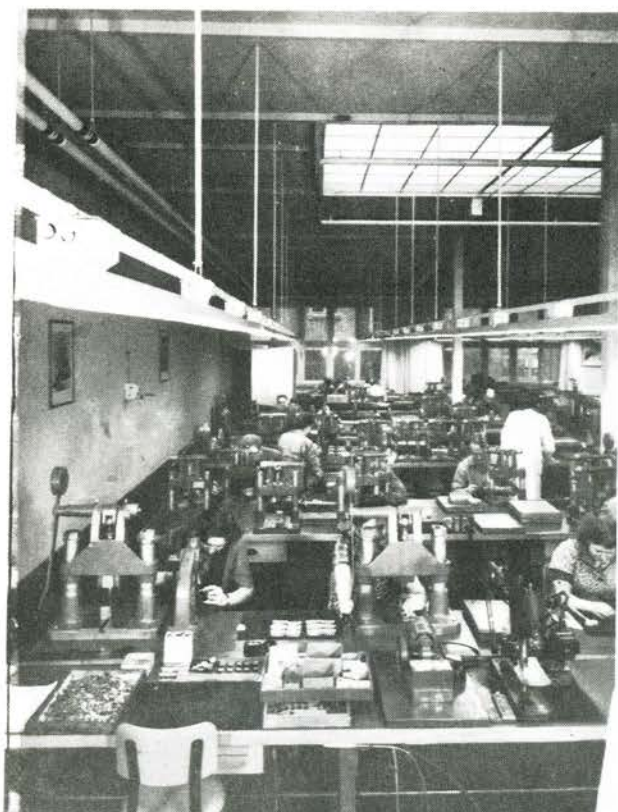
Mekanisk montageafdeling. Håndpresserne benyttes til at nitte dele sammen.
